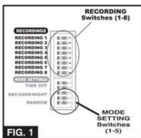
Za podešavanje aparata koristite mali šrafčiger, čačkalicu i sl. Za pomeranje malih prekidača u nizu (vidi FIG 1). Niz prekidača se nalazi u donjem desnom uglu uređaja. **Prekidač je uključen ako je pomeren na desnu stranu. Prekidač je isključen ako je pomeren na levu stranu.**
